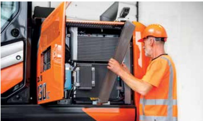
Vergrote radiateurdeur (ZX130-7B) biedt eenvoudig toegang voor reiniging en onderhoud.
