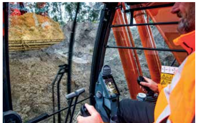
Parallelruitenwissers verbeteren het zicht.
