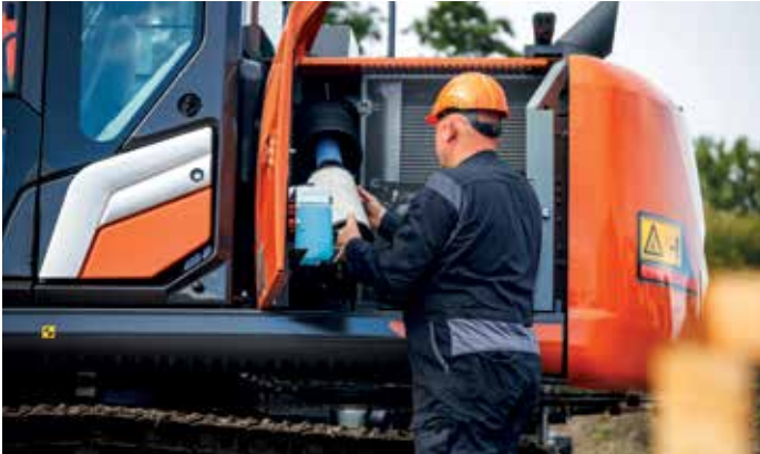
Toegang tot filters is verbeterd bij de ZX135US-7B.
